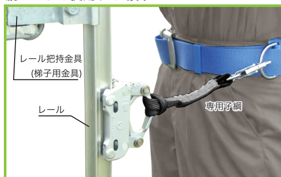
専用子綱を使用した胴ベルトのD環との接続方法
