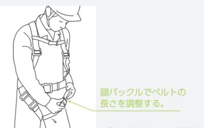
腿バックルでベルトの長さを調整する。
