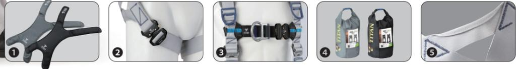
①[ショルダーパッド] 肩の負担を減らす他、ハーネスの型崩れを防ぎ着脱をスムーズにします。②[High Speed Quick Buckle] このハーネスのために開発された腿部のワンタッチバックル・HSQBがハーネスの着脱をスムーズにします。③[交換可能なチェストベルト(別売り)] 別売りのD環付きチェストベルトに付け替れば、昇降移動時等に便利に、安全にお使い頂けます。④[ベルトカラーに合わせたスタッフバッグ] バッグに丁寧に梱包し、皆様のお手元にお届けします。開封後はスタッフバッグとしてご利用頂けます。⑤腿のループ形状を保持する目的でベルトの一部を折り返して縫製しています。
