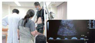
三脚を用いて被験者をウインチで吊り上げ、墜落制止後の宙吊りを再現し、エマージェンシーストラップ2を使用した状態で、大腿静脈を中心にエコー(超音波)を用いて血流の測定を実施。
